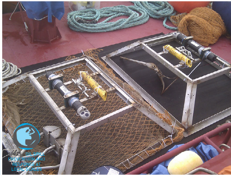
ADCP montado numa estrutura de aço com dispositivo acústico (compensado para evitar o afundamento em sedimentos finos)
